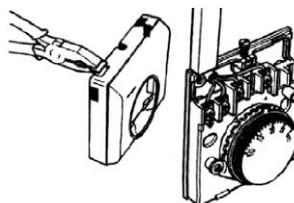
5. Присоедините провода к клеммам, как показано на рисунке. Максимальная длина оголенного провода не более 9 мм.
