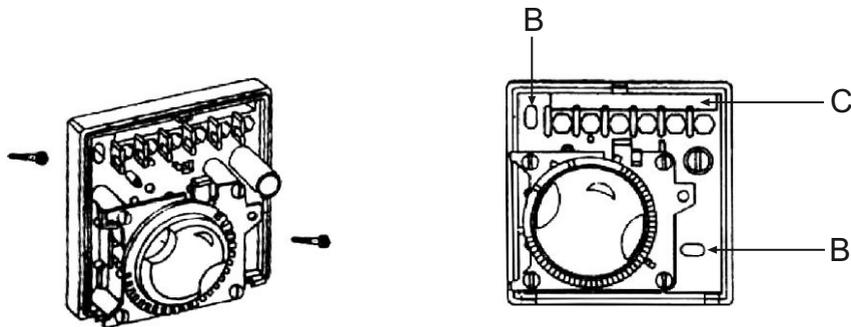
Проведите кабель в специальное отверстие С в основании, и соедините его с клеммами согласно схеме, приведенной в п.4.
