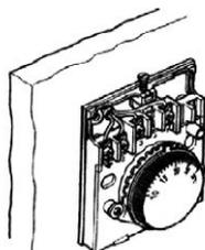
4. Если кабель проложен поверх стены, сделайте для него вырез в крышке термостата при помощи плоскогубцев, как показано на рисунке.
