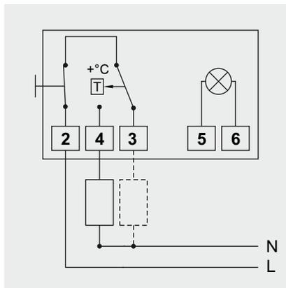
Электрическая схема термостата PF TR 643:
