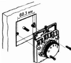
3. Если кабель проложен в стене, пропустите его в отверстие в основании термостата сверху от клемм.
