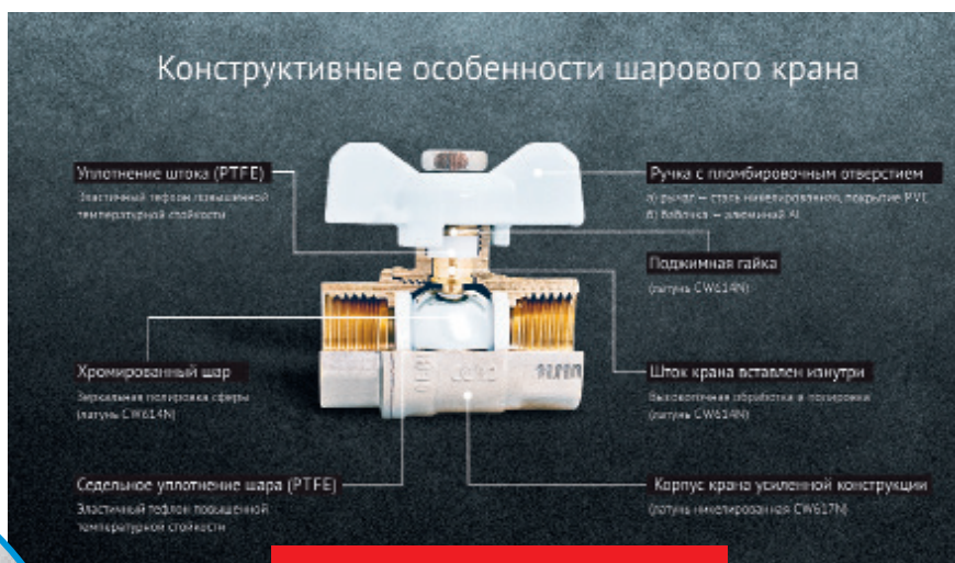
Устройство шарового крана.
