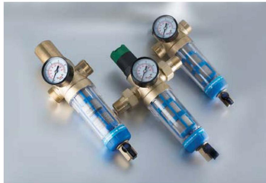
Чтобы защитить всю водопроводную систему в доме и сохранить в рабочем состоянии арматуру и оборудование, присоединенные к ней, промывной фильтр устанавливается перед счетчиками воды, регулирующей арматурой, расходомерами или насосами. Неочищенная вода попадает в фильтр через входное отверстие и проходит через фильтрующую сетку к выходному отверстию. При этом механические примеси задерживаются на внешней стороне сетки, а очищенная вода попадает во внутреннюю систему трубопроводов.
