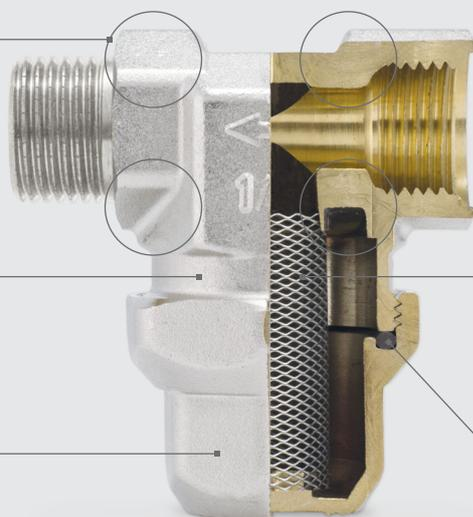
Для обеспечения правильной работы Т-образные фильтры устанавливаются в горизонтальном положении крышкой ревизии вниз. Стрелка на корпусе фильтра должна совпадать с направлением потока фильтруемой среды.
