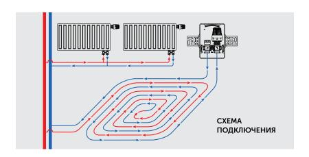
**РЕКОМЕНДАЦИЯ!** Следует обратить внимание, чтобы термостатическая головка регулировочного модуля находилась на достаточном расстоянии от всех источников тепла и холода. В этой связи, не рекомендуется устанавливать модуль вблизи радиаторов, горячего трубопровода, на сквозняке или под солнечными лучами, так как постороннее воздействие на термоголовку может негативно отразиться на эффективности работы устройства.
